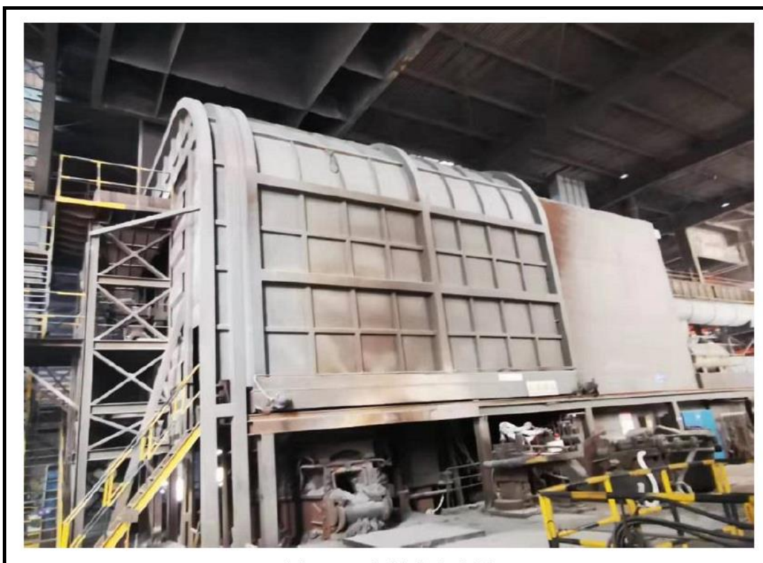
图 8.1-1 密封收集罩 (示意图)
